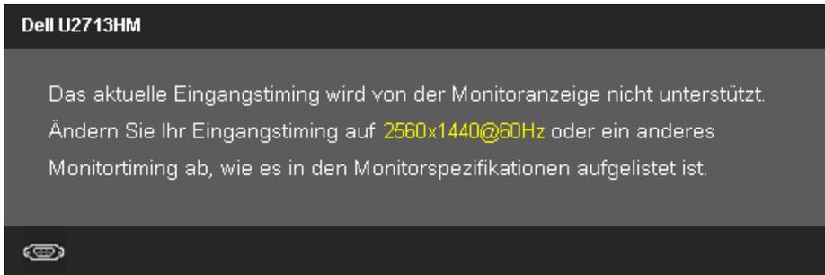
Das bedeutet, dass sich der Monitor nicht richtig auf das Signal einstellen kann, das er vom Computer empfängt. In den [technischen Daten zum Monitor](#) finden Sie die von Ihrem Monitor unterstützten Horizontal- und Vertikalfrequenzen. Die empfohlene Auflösung beträgt 2560 x 1440.
