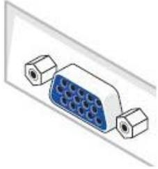
**✎ HINWEIS:** Sofern Ihr Computer über einen weißen DVI-Anschluss verfügt, lösen Sie die Schrauben und trennen das blaue VGA-Kabel vom Monitor. Schließen Sie dann das weiße DVI-Kabel an die DVI-Anschlüsse von Monitor und Computer an.
